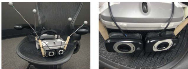
(a) COTS VSTHMD (b) COTS VSTHMD attachment detail.
